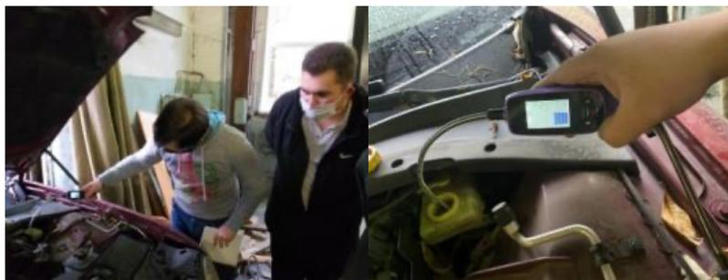
Рисунок 2 – Проведение экспресс-контроля состояния тормозной жидкости прибором IC-145
