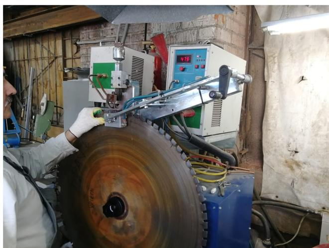
Рисунок 3 – Напайка алмазных сегментов
