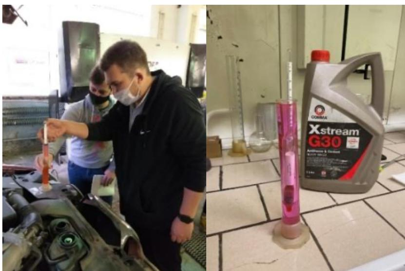
Рисунок 3 – Взятие образца используемой и новой охлаждающей низкозамерзающей жидкости
