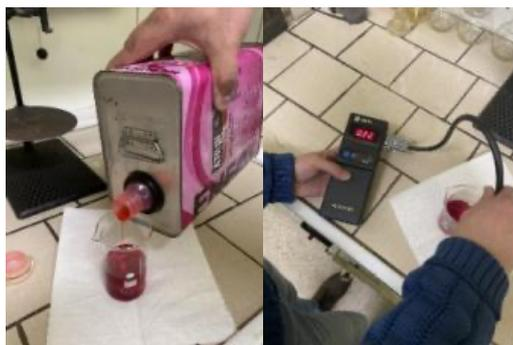
Рисунок 1 – Измерение степени чистоты трансмиссионного масла марки ENEOSAF 3 DEXTRON прибором ИЗЖ-М
