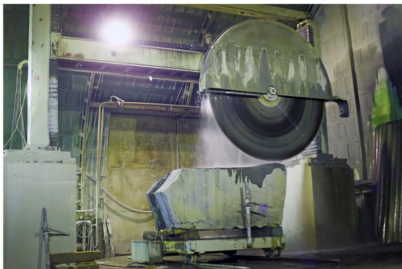
Рисунок 1 – Распилка камня диском с алмазными сегментами
