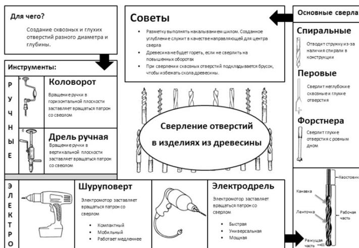
Рис.1. Фрейм по теме «Сверление отверстий в изделиях из древесины»
