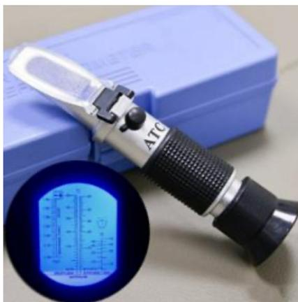
Рисунок 5 – iCartoolIC-803 со шкалой измерений
