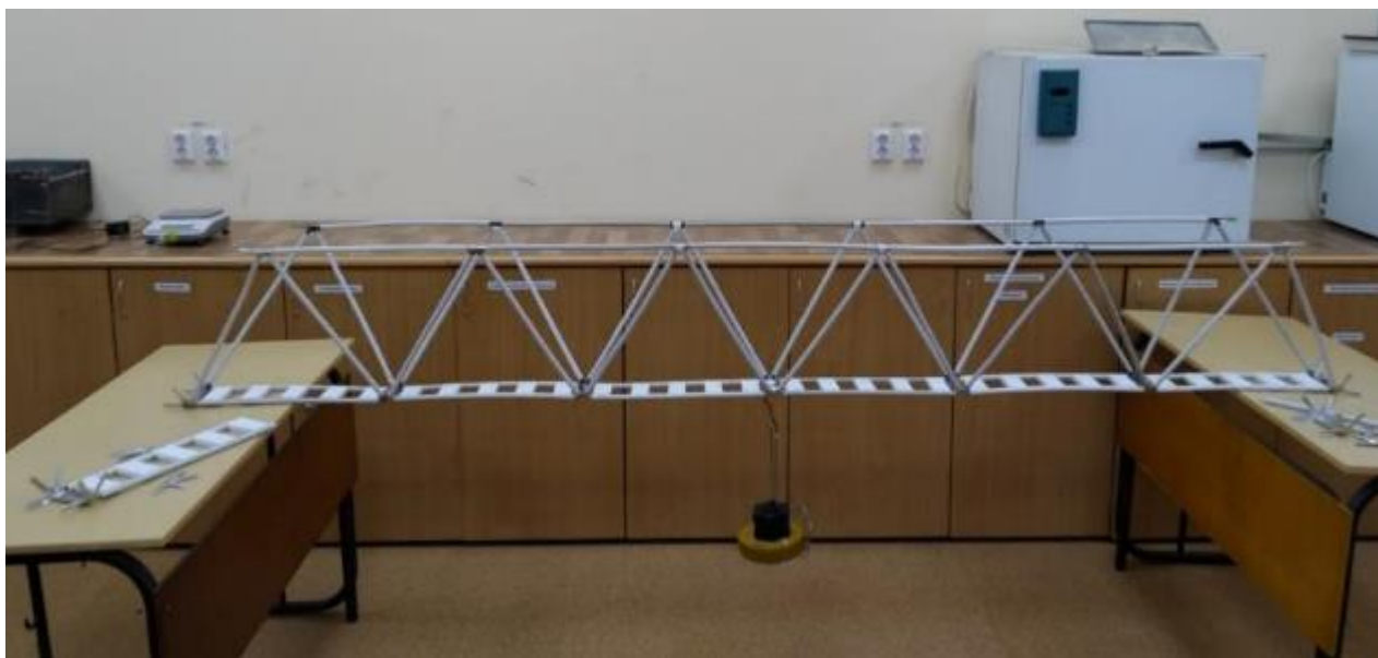
Рис. 3. Испытание модели моста в масштабе 1:2,5 в лаборатории ПетрГУ. Фото автора.
