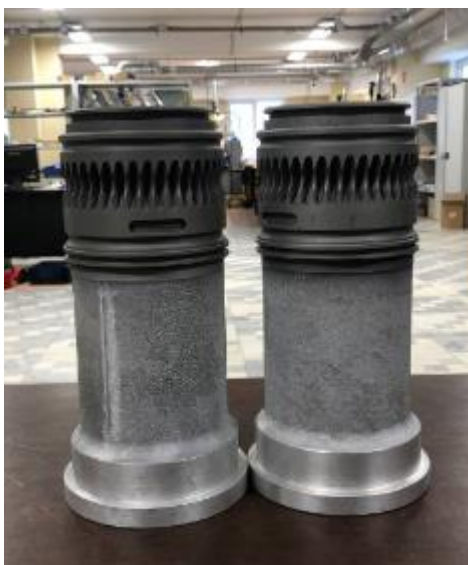
Рис. 2. Детали с полученными покрытиями
